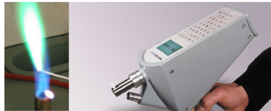
Links: „Selbstbau-Spektrometer“; Nachweis von Kupfer mit der Flammenfärbung.
